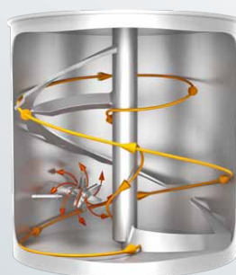
Aufwärtsbewegung in der Peripherie des Mischraumes, Abwärtsbewegung im Zentrum des Gefäßes
