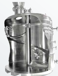
Schraubenband, Arme und Welle sind vollständig temperierbar.
