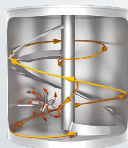
Movimiento ascendente en la periferia del tanque de mezcla, movimiento descendente en el centro del recipiente.
