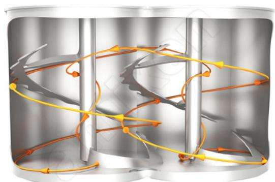
Principe d'écoulement du mélangeur HM
