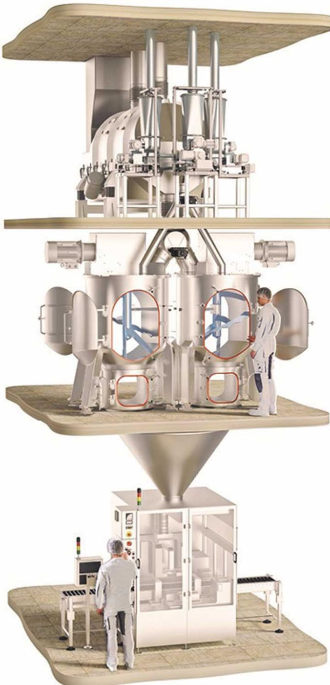
Ce deuxième concept est connu sous le nom d'opération en bout de chaîne et implique une disposition verticale des équipements de traitement dans laquelle les matériaux s'écoulent de manière gravimétrique et continue vers l'étape suivante du processus.
