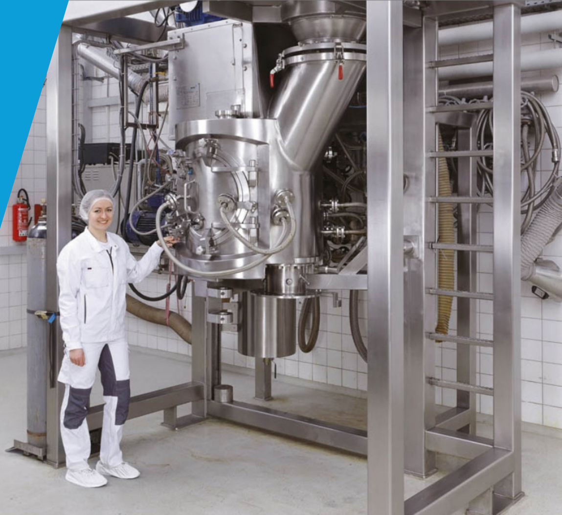
amixon® вакуумный смеситель-сушилка и вакуумный реактор VMT
