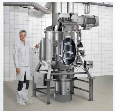
Typ KS 400 z 2 drzwiczkami inspekcyjnymi projektu Clever-Cut®
