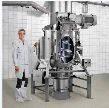
특허 방식(Clever-Cut®)으로 Cutting 제작된 기밀구조의 대형 점검구가 2개소 설치된 KS400 Model
