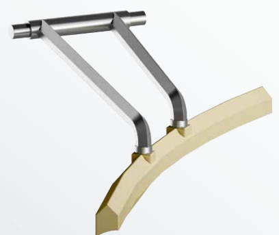
ComDisc® per lo svuotamento dei residui: Durante l'ultima fase di svuotamento, gli elementi ComDisc® rivestono il fondo.
