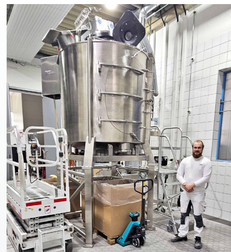
Il mescolatore di prova Gyration® è adatto per lotti fino a 3 m³. A tenuta di gas, igienico, applicabile universalmente.
