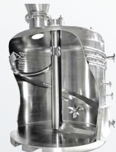
Température du ruban hélicoïdal, des bras et de l'arbre entièrement réglable.
