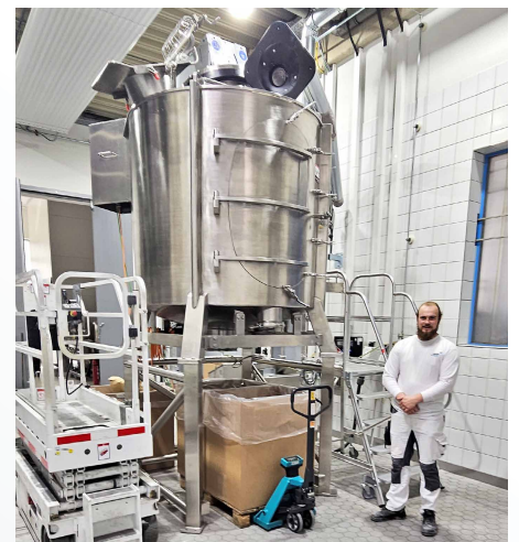
Le mélangeur d'essai Gyration® convient pour des lots allant jusqu'à 3 m³. Étanche aux gaz, hygiénique, utilisation universelle.
