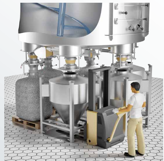
Il est possible d'optimiser le processus d'alimentation par l'installation de plusieurs dispositifs de vidange.
