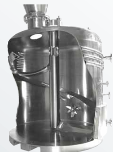
Kierresekoitin, varsi ja akseli ovat täysin lämpösäädettäviä.
