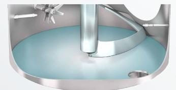
Mezclador montado rigidamente: Hay menos flujo por el centro. Por lo tanto, la frecuencia de rotación debe ser superior a 4-7 rpm.
