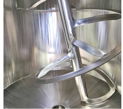
La base tiene forma de segmento esférico. La mezcla se mezcla sin espacios muertos. Si es necesario, la mezcla puede incluso descargarse por completo utilizando ComDisc®.
