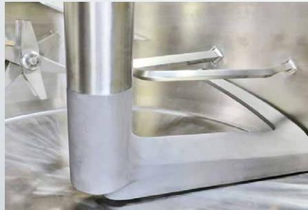
Keramische Plasmabeschichtung dient dem Verschleißschutz
