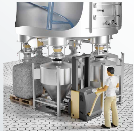
Die Abfüllung kann beschleunigt werden, wenn mehrere Austragsvorrichtungen installiert werden.
